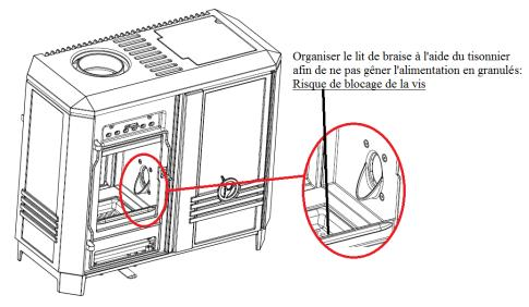
Dégager les résidus de cendres accumulés sous le creuset (à l'aide d'un tisonnier), vider le cendrier si nécessaire : la zone du cendrier située sous le creuset doit être parfaitement dégagée (voir sur le schéma ci-dessous, le cône d'accumulation de cendre qu'il faut « dégager » ).
